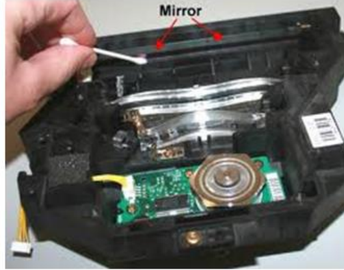
تنظيف وحدة الليزر
